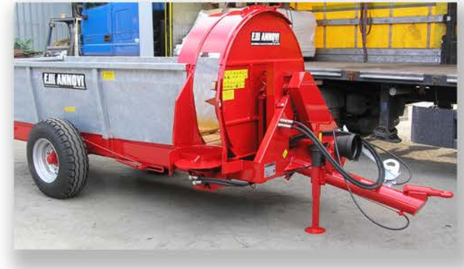
Kit freno meccanico omologato su strada (a richiesta aggiunta freno idraulico). Brakes set (mechanical | hydraulic | pneumatic).
