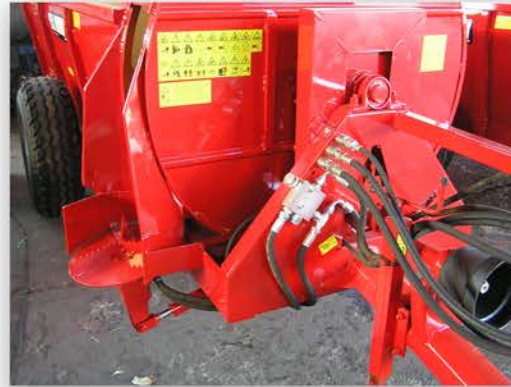
Valvola di regolazione velocità rotazione piatto idraulico.
