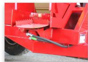
Piatto localizzatore a piede filare idraulico Lateral disc to localize manure on the row - hydraulic
