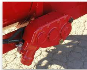
Avanzamento tappeto idraulico a velocità regolabile Hydraulic chain conveyor with adjustable speed
